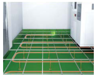
프리 액세스 플로어에 센서를 설치
